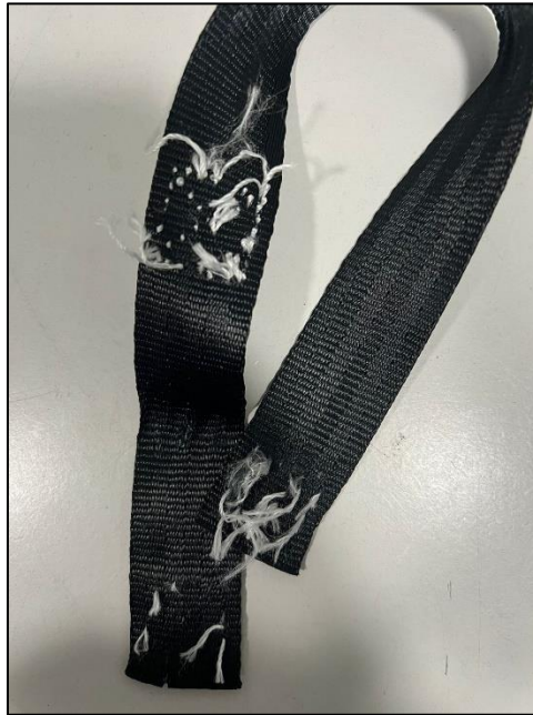
Img 1: Se produjo la rotura en la zona de las costuras de la cinta
